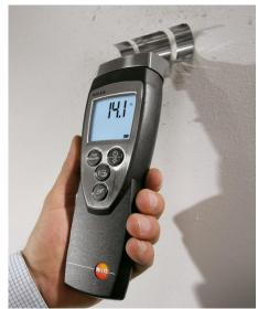
Testo 616, appareil de mesure de l'humidité du bois et des matériaux de constructions livré avec piles et protocole d'étalonnage.
